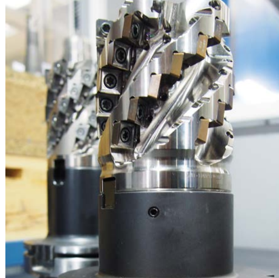
Fraise ASPX au premier plan ; Fraise VFX au second.
