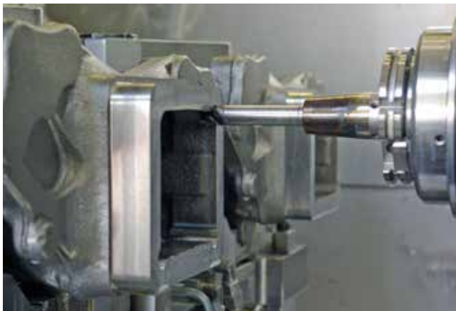
4 Deux fusées d'essieu sont toujours usinées en même temps sur un Hüller Hille BA600 avec les fraises toriques iMX. L'outil usine uniquement avec les arêtes frontales. Les fraises 16 mm sont d'une grande fiabilité avec de longues durées de vie (photo: Hanser)
