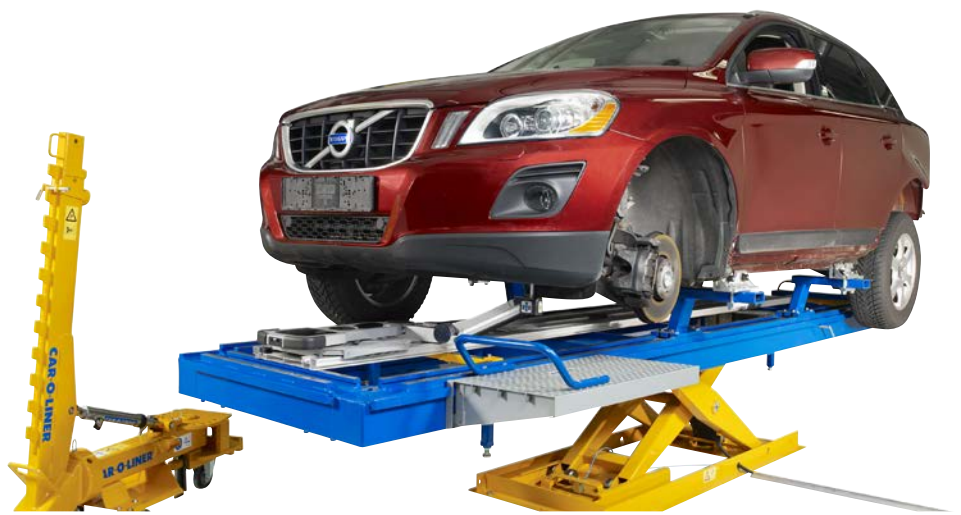
Die Car-O-Liner Richtbank im Einsatz – Ermittlung des Ausmaßes einer Beschädigung durch Fehlausrichtung
