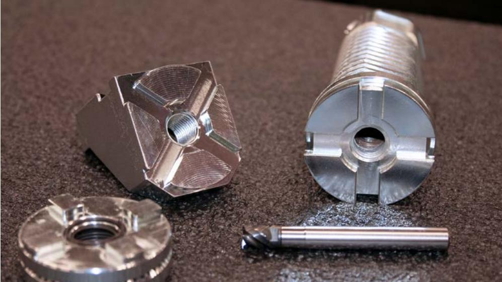
Fresa de cabeza intercambiable iMX y componentes de sujeción mecanizados terminados
