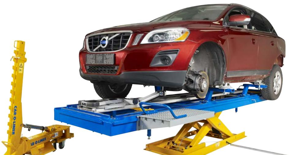
Banco de enderezado de Car-O-Liner en acción: determinación de la gravedad de los daños por desalineación.
