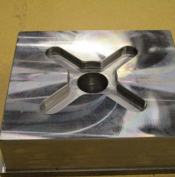
Pieza mecanizada: hembra de la sujeción modular
