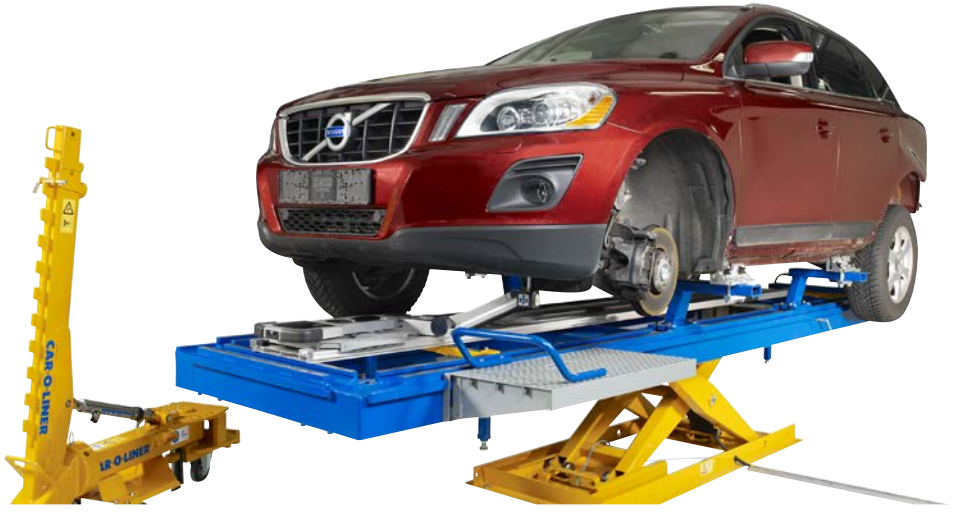
Car-O-Liner tezgahı hasar doğruluk derecesinin belirlenmesinde kullanılır.
