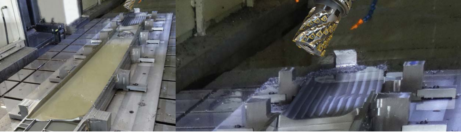
Beim Fräsen eines Werkstücks von 3,5 m Länge aus Titan können bis zu einer Tonne Späne erzeugt werden
