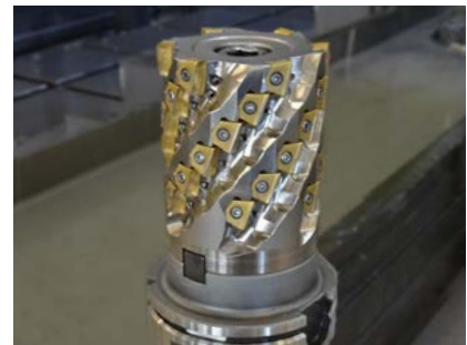
Głowica frezarska nasadzana typu VFX-5
