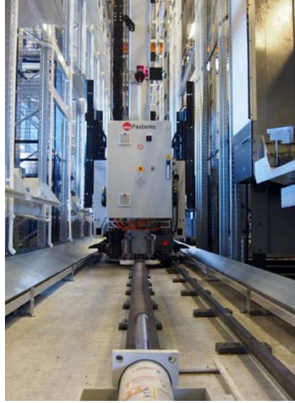
Palletising machine for the Figeac Aéro workshop CNC.
