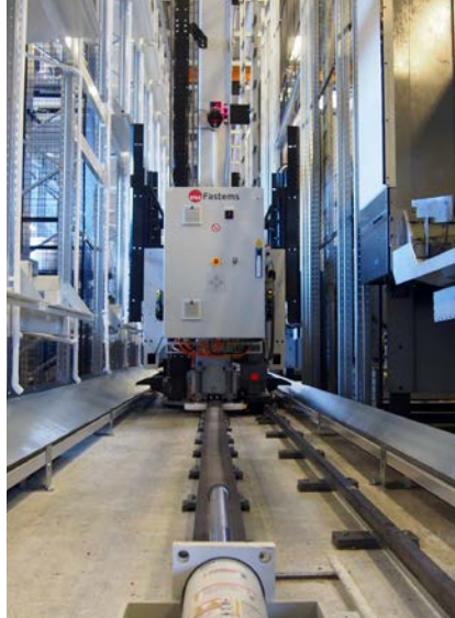
Macchina con cambio pallet per l'officina CNC di Figeac Aéro.
