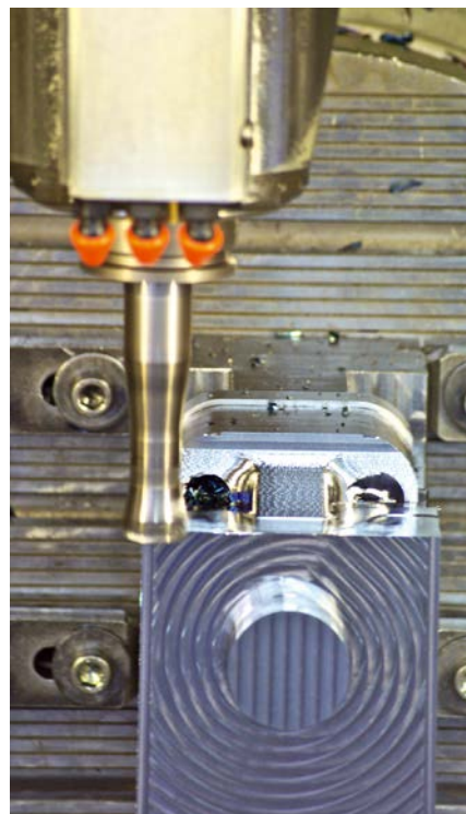
4 Unterbrochener Schnitt bei einer Spritzverteilung: Die MP6130 marschiert
