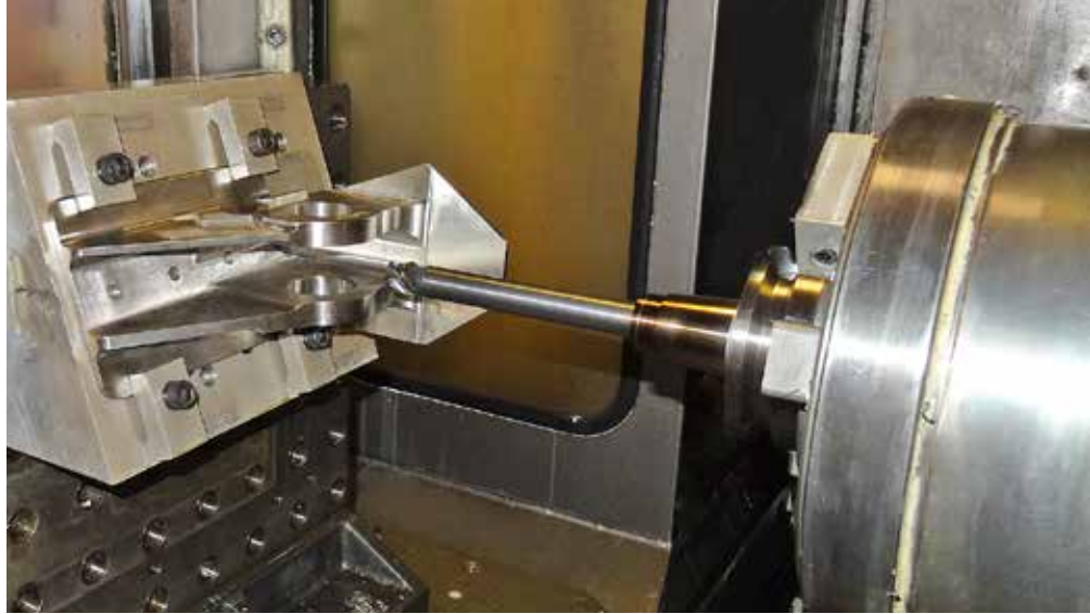
Eine Strebe, die mit dem iMX-Wechselkopf-System von Mitsubishi Materials bearbeitet wird
