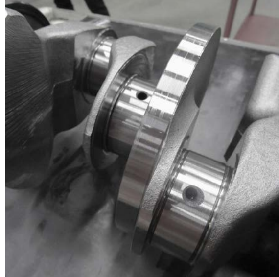
Diagonalbohrung, 5,00 mm Durchmesser, 100 mm Tiefe.
