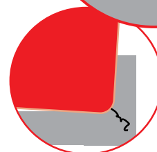
Inserto convenzionale Rotture e scheggiature sullo spigolo
