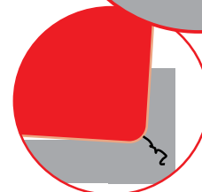
Płytki konwencjonalne Pęknięcia i wykruszenia krawędzi
