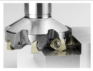
positiva. Ciò produce sforzi di taglio ridotti, mentre lo spessore dell'inserto maggiore rispetto alle tipologie convenzionali offre un'ottima resistenza alla rottura. Inoltre, una profondità di taglio massima fino a 8,2 mm consente una precisa lavorazione in spallamento. Al fine di soddisfare le aspettative di finitura della superficie, il fondo di tutti gli inserti presenta una geometria ad ampio raggio che si comporta come un tratto raschiante (wiper) tradizionale.
